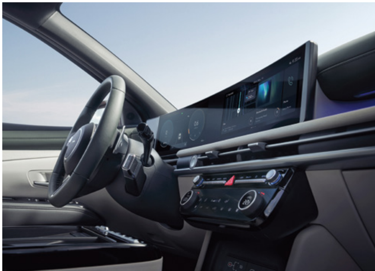
Панорамный изогнутый дисплей: приборная панель диагональю 12,3 дюйма и центральный дисплей диагональю 12,3 дюйма
