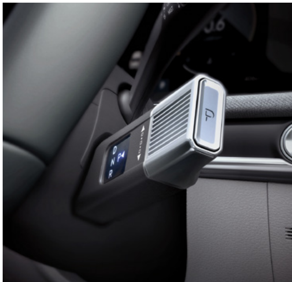
Рычаг селектора передач на рулевой колонке (SBW)
