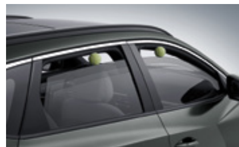
Электрические стеклоподъемники с функцией защиты от защемления
