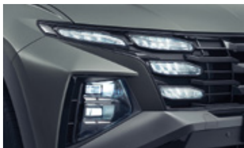
Полностью светодиодные фары головного света (широкий угол освещения и интеллектуальная система управления светом IFS)
